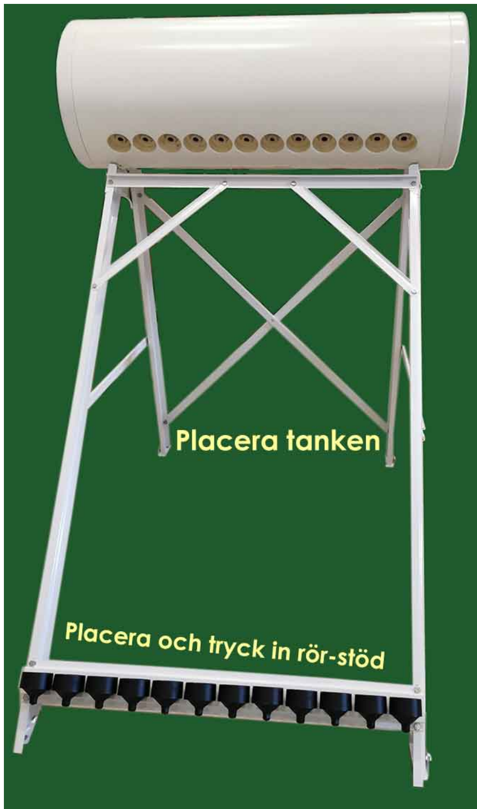
Bild 10: placera tanken och sätt muttrarna. Se till att dykarrör-hålen i i tanken är riktade i linje med rörstödet i botten. Låt tanken vara något "lös" för att kunna vrida något när du sätter in de första vakuumrören, om det skulle behövas. (se också texten efter bild 13).
