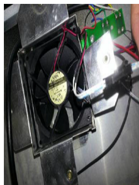
Steg 3: Dra ut kabelkontakten på fläkten och byt ny fläkt.
