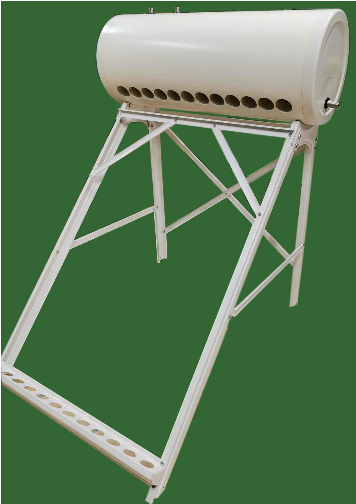
Bild 10: placera tanken, dra inte i muttrarna hård, låt tanken vara lite lös för att kunna vrida något när du sätter in första vakuumröret.
